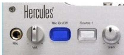
Connectez la console, **en maintenant** appuyé le bouton **MIC On/Off**
