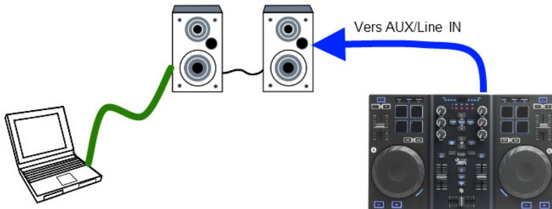
Si c'est le cas de vos enceintes, relier simplement la sortie principale de votre console DJ à l'entrée auxiliaire en utilisant le câble approprié.
